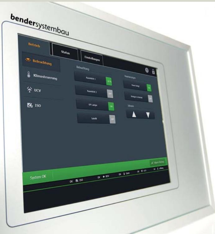
informationen werden klar und gegliedert angezeigt. Das integrierte I/O-System bietet zahlreiche Optionen für die Einbindung von digitalen und analogen Signalen mit unterschiedlichen Betriebsspannungen, Leistungen, Mess-Signalen und speziellen Funktionen in einem Melde- und Bedientableau.
