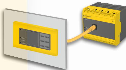
La unidad de pantalla FP200 se monta por medio de clips de retención en el panel y se conecta mediante el cable suministrado RJ45 con el dispositivo básico sin pantalla. Esta opción de montaje permite la instalación de la pantalla remota del dispositivo en el frontal del cuadro de distribución sin llevar a ese punto los cables de conexión al sistema con tensiones de hasta 1.000 V.
