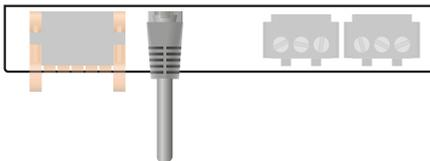
Anschluss mit Standard-Patch-Kabel (RJ45/kein Crossover-Kabel) zu anderen ISOMETER®n oder Vernetzung mehrerer ISOMETER® in Stern-Topologie mittels Switch.
