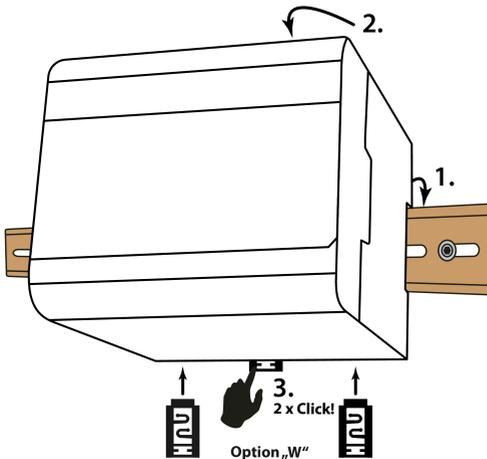
1. Gerät auf der Hutschiene einhängen.
