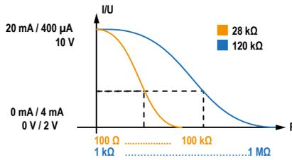
Berechnung des Isolationswiderstandes über den Analogausgang:
