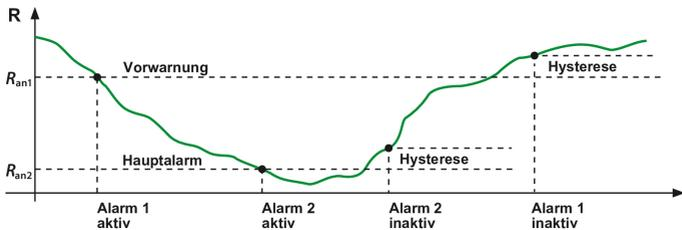
Für die Vorwarnung und den Hauptalarm kann jeweils ein Isolationswiderstand von  $200 \Omega \dots 1 \text{ M}\Omega$  eingestellt werden. Bedingung: Vorwarnung  $\geq$  Hauptalarm.
