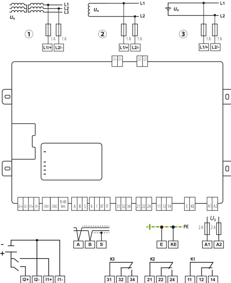
**1** [L1/+, L2/-]: Anschluss an ein 3(N)AC-Netz
