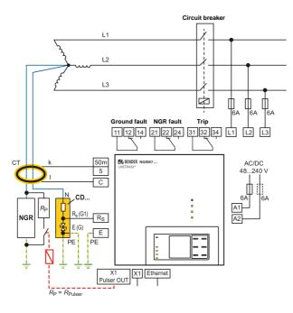
Figure 4-3: Anschluss  $U_{sys} \le 690$  V mit Pulser
